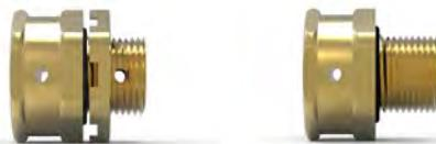
Die Klimastutzen sorgen für einen ständigen Druckausgleich zwischen dem Gehäuseinnenraum und der umgebenden Atmosphäre. Dadurch wird verhindert, dass Feuchtigkeit in das Gehäuse eintritt und dort kondensiert.
