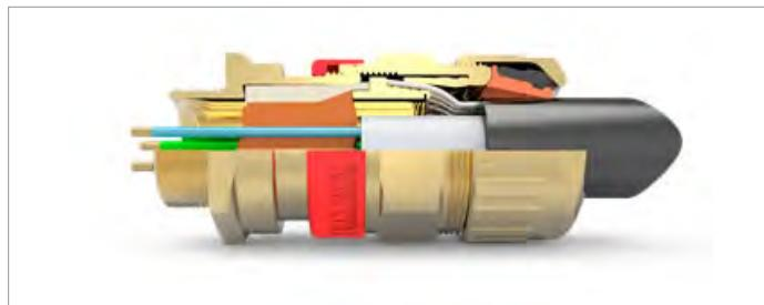
Vergussmassen-Kabelverschraubung für armierte und geschirmte Leitungen, bei der nach der Installation die Vergussmasse überprüft und wenn notwendig ausgebessert werden kann. Geeignet für alle Arten von Armierung und Schirmgeflechten.
