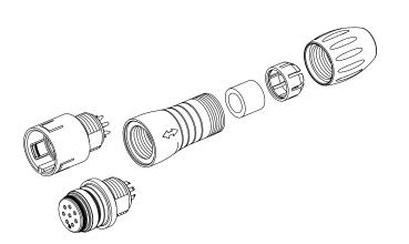
Steckereinsatz Buchseneinsatz Kupplungshülse Dichtring Klemmkorb Druckschraube
