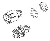
Steckereinsatz Buchseneinsatz Flachdichtung Sechskantmutter
