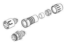
Steckereinsatz Buchseneinsatz Kupplungshülse Dichtring Klemmkorb Druckschraube
