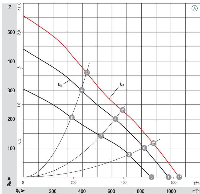
Luftleistung gemessen nach: ISO 5801, Installationskategorie A, in ebm-papst Spiralgehäuse ohne Berührschutz. Saugseitige Geräuschpegel: L<sub>pA</sub> nach ISO 13347, L<sub>pA</sub> mit 1 m Abstand auf Ventilatorachse gemessen. Die Angaben gelten nur unter den angegebenen Messbedingungen und können sich durch Einbaubedingungen verändern. Bei Abweichungen zum Normaufbau sind die Kennwerte im eingebauten Zustand zu überprüfen! Detailinformationen siehe <http://www.ebmpapst.com/rahmenbedingungen>
