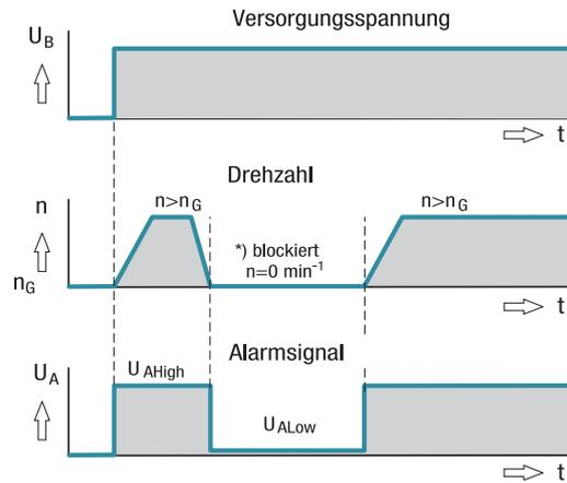
\* Grenzdrehzahl  $n_G = 0 \text{ min}^{-1}$
