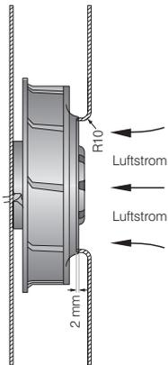
Förderleistung und Geräusch von Radiallüftern ohne Außengehäuse hängen von ihren Einbauverhältnissen ab. Der genannte Volumenstrom und das Geräusch wurden unter folgenden Messbedingungen ermittelt:
