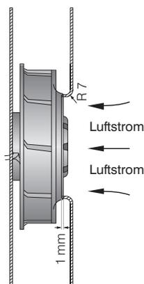
Förderleistung und Geräusch von Radiallüftern ohne Außengehäuse hängen von ihren Einbauverhältnissen ab. Der genannte Volumenstrom und das Geräusch wurden unter folgenden Messbedingungen ermittelt:
