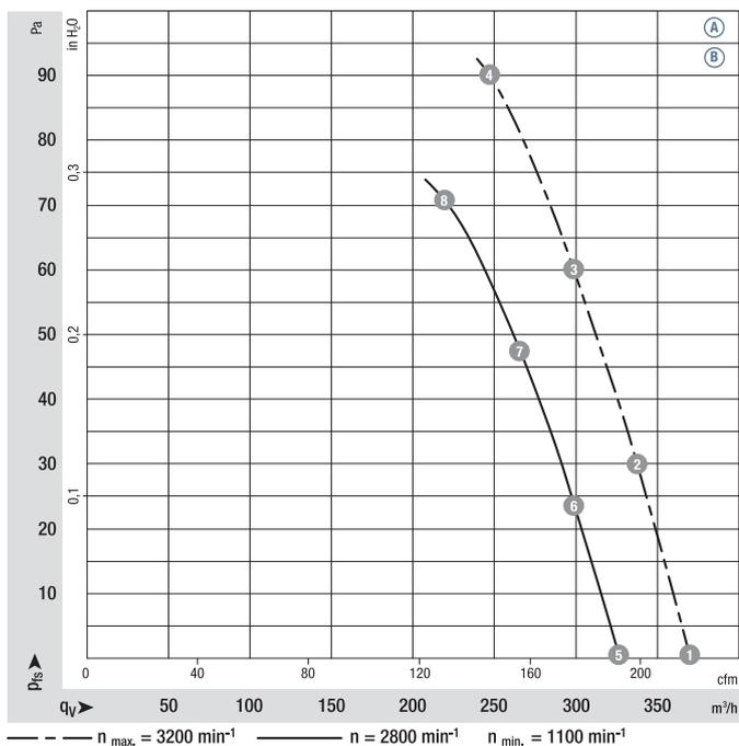
Luftleistung gemessen nach: ISO 5801, Installationskategorie A, in ebm-papst Voldüse ohne Berührungsschutz. Saugseitige Geräuschpegel: L<sub>WA</sub> nach ISO 13347, L<sub>pA</sub> mit 1 m Abstand auf Ventilatorachse gemessen. Die Angaben gelten nur unter den angegebenen Messbedingungen und können sich durch Einbaubedingungen verändern. Bei Abweichungen zum Normaufbau sind die Kennwerte im eingebauten Zustand zu überprüfen! Detailinformationen siehe <http://www.ebmpapst.com/rahmenbedingungen>
