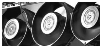
Lüfter in einem Dauerlaufschrank von ebm-papst. 1500 Lüfter werden hier bis zu deren Ausfall in Temperaturschränken betrieben.
