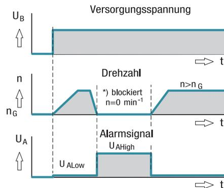
\* Grenzdrehzahl  $n_G = 0 \text{ min}^{-1}$
