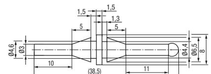
Gummi-Montagestopfen für Lüfter mit Bohrungsdurchmesser 4,3  $\pm$ 0,2 mm und Flanschdicke 2...4 mm. Für Trägerblech mit Bohrungsdurchmesser 4,4  $\pm$ 0,15 mm und Blechdicke 1...2 mm.
