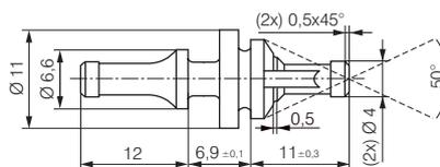
Gummi-Montagestopfen für Lüfter mit Bohrungsdurchmesser 4,3  $\pm$ 0,2 mm und Flanschdicke 3...5,5 mm. Für Trägerblech mit Bohrungsdurchmesser 6,5  $\pm$ 0,15 mm und Blechdicke 1...2 mm.
