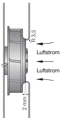
Förderleistung und Geräusch von Radiallüftern ohne Außengehäuse hängen von ihren Einbaueinrichtungen ab. Der genannte Volumenstrom und das Geräusch wurden unter folgenden Messbedingungen ermittelt:
