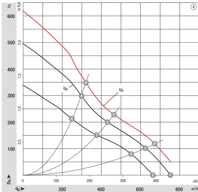
Luftleistung gemessen nach: ISO 5801, Installationskategorie A, in ebm-papst Spiralgehäuse ohne Berührschutz. Saugseitige Geräuschpegel:  $L_{pA}$  nach ISO 13347,  $L_{pA}$  mit 1 m Abstand auf Ventilatorachse gemessen. Die Angaben gelten nur unter den angegebenen Messbedingungen und können sich durch Einbaubedingungen verändern. Bei Abweichungen zum Normaufbau sind die Kennwerte im eingebauten Zustand zu überprüfen! Detailinformationen siehe <http://www.ebmpapst.com/rahmenbedingungen>
