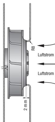
Förderleistung und Geräusch von Radiallüftern ohne Außengehäuse hängen von ihren Einbaubedingungen ab. Der genannte Volumenstrom und das Geräusch wurden unter folgenden Messbedingungen ermittelt: Montage des Radiallüfters auf einer Grundplatte 266 x 266 mm. Deckplatte 266 x 266 mm, mit einer Lufteinlassöffnung von Ø 100 mm, konzentrisch zum Lüfterrad.
