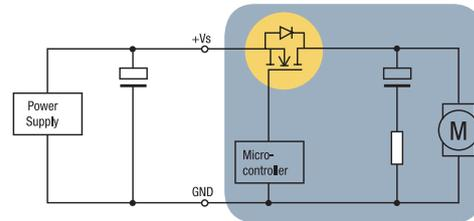
Empfohlene Maßnahme: Zusätzlicher externer Kondensator (dieser sollte so nahe wie möglich am Lüfter angebracht werden < 30 cm).
