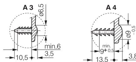
Nur passend für Bohrungsdurchmesser
