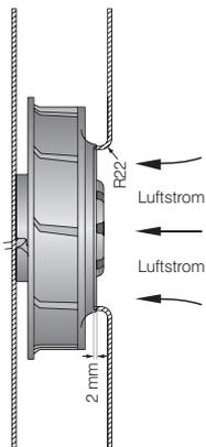
Förderleistung und Geräusch von Radiallüftern ohne Außengehäuse hängen von ihren Einbauverhältnissen ab. Der genannte Volumenstrom und das Geräusch wurden unter folgenden Messbedingungen ermittelt:
