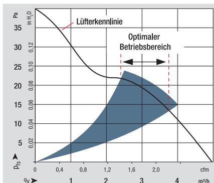
Druckerzeugung; der Volumenstrom bleibt unbeeinflusst. Die Druckerzeugung lässt sich näherungsweise mit  $\Delta p_2 = \Delta p_1 (\rho_2 / \rho_1)$  für andere Werte der Luftdichte umrechnen.
