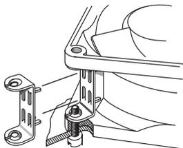
Bügelfeder Mutter aus rostgeschütztem Federstahl. Zur Befestigung von Lüftern mit einer Gewindeschraube 3,5 DIN EN ISO 1478 (7970).
