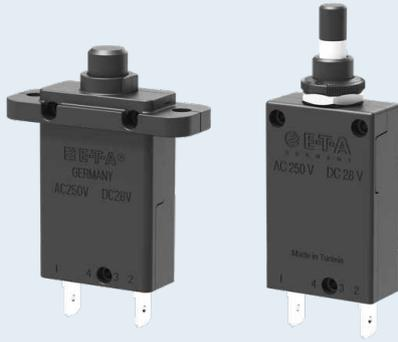
Einpolige thermische Reset-Schutzschalter, verschiedene Befestigungsarten. Typ 2-5700 auf Wunsch in Druck-Druck-Ausführung, d. h. mit manueller Ausschaltmöglichkeit. Zuverlässiges Schaltverhalten durch Sprungschaltmechanismus und Freiauslösung. Weitere Ausführungen wie 2-5200 und 2-6400 erhältlich.
