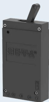
Einpoliger, thermisch-magnetischer Schutzschalter in Kleinbauweise mit Kipphebelbetätigung, Printplattenbefestigung, unbeeinflussbarer Freiauslösung, verschiedenen Kennlinien und wahlweise Hilfskontakten. Einsetzbar auch in Stromverteilungssystemen.
