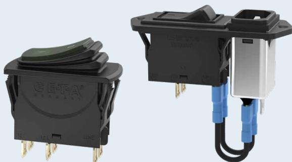
Ein- bis dreipolige thermische Schalter/Schutzschalter Kombinationen. Zeit sparende snap-in Montage. Wippen- und Drucktastenausführungen. Optional mit Beleuchtung, Spritzwasser/Staubschutz und Anbaumodulen, z. B. Unterspannungsauslöser. Zuverlässiges Schaltverhalten durch Freiauslösung. Thermisch-magnetische Ausführung siehe 3120-M.
