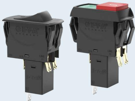
Kombination von Schutzschalter und EIN/AUS-Schalter mit Schaltwippe oder Druckknopf, zweipolig (erster Pol thermisch-magnetisch geschützt, zweiter Pol thermisch geschützt oder ungeschützt), Frontmontage. Schaltwippe bzw. Druckknopf kann auf Wunsch beleuchtet und in verschiedenen Farben geliefert werden. Zuverlässiges Schaltverhalten durch unbeeinflussbare Freiauslösung.
