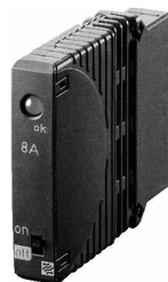
DC 24 V - Schaltnetzteile werden in der Automatisierungstechnik sehr häufig eingesetzt. Bei Überlast regeln sie jedoch die Ausgangsspannung, die alle angeschlossenen Lasten versorgen soll, ab. Tritt also an einem einzigen Verbraucher der Anlage ein Fehler auf, bricht auch in den anderen Lastkreisen die Spannung ein. Häufig hat das nicht nur einen undefinierten Fehlerzustand zur Folge, sondern sogar einen Stillstand der Maschine oder Anlage.
