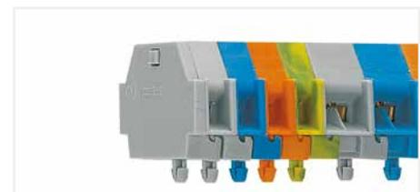
Klemmenleiste; mit Rastfüßen; für Blechdicke 0,6 ... 1,2 mm; Befestigungsloch Ø 3,5 mm (auch für Aluminiumtragschiene (210-154) oder mit Montagefuß (209-120) für Tragschiene 35)
