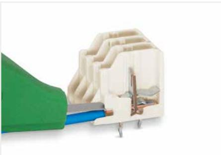
Leiter lösen am PUSH WIRE®-Anschluss – Lösewerkzeug oberhalb des Leiters bis zum Anschlag einschieben und Leiter herausziehen.
