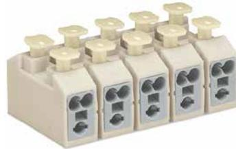
Teilbare Klemmenleisten; mit zusätzlichem Steckklemmanschluss für 0,5/0,75 mm<sup>2</sup> H07V-U (NYA) pro Pol; für Schraub- oder schraubenlose Befestigung (WAGO-Verbindungsstifte); PE-Kontakt; wahlweise für Schraub-/Nietanschluss oder Rastkontakt (steckbar)
