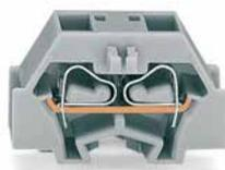
2-Leiter-Klemme; mit Befestigungsflansch; für Schraub- u. ä. Befestigungsarten; Befestigungsloch Ø 3,2 mm; mit Montagefuß (209-123) auch für Tragschiene 35
