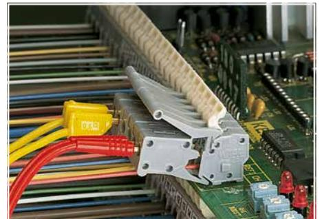
Leiter anschließen/lösen – Serie 257.
