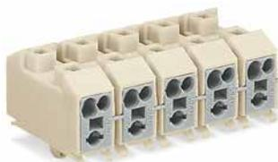
Teilbare Klemmenleisten, mit zusätzlichem Steckklemmanschluss für 0,5/0,75 mm<sup>2</sup> H07V-U (NYA) je Pol, für Schraub- oder schraubenlose Befestigung » (WAGO-Verbindungsstifte); mit Rastfuß zum Einrasten in Rastlöcher Ø 3,5 mm, Befestigungsblech 0,6 ... 1,2 mm dick; PE-Kontakt, wahlweise für Schraub-/Nietanschluss oder Rastkontakt (steckbar)
