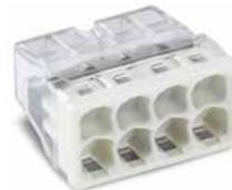
COMPACT-Verbindungs-dosenklemme; 8-Leiter-Klemme; Gehäusefarbe transparent; Dauergebrauchstemperatur max. 105 °C; Umgebungstemperatur max. 60 °C
