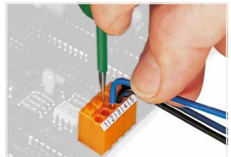
Leiter mittels Drückers lösen.
