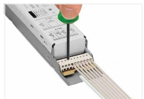
Leiter mittels Lösewerkzeug (Ø 1,0 mm; 206-841) lösen.
