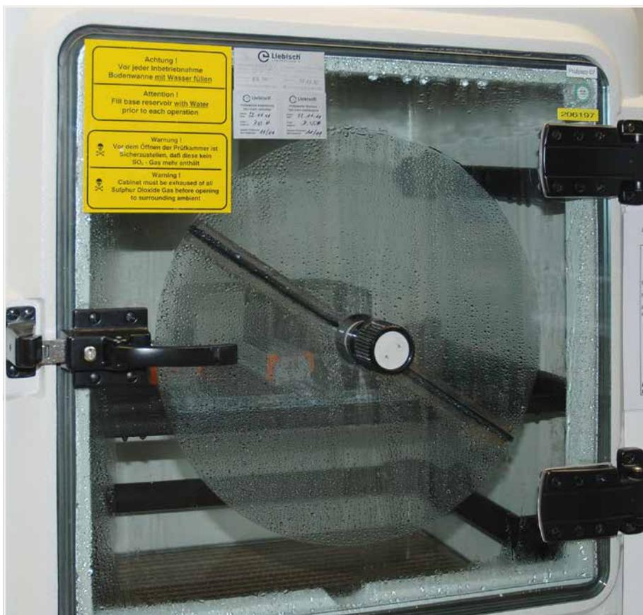
Bei diesem Test wird zunächst in einem Klimaschrank eine wässrige Schwefeldioxidlösung erwärmt. Es entsteht eine gesättigte Atmosphäre, in der der Prüfling durch kondensierende Dämpfe nach weniger als einer halben Stunde vollständig befeuchtet ist. Er verbleibt in dieser Atmosphäre für acht Stunden.
