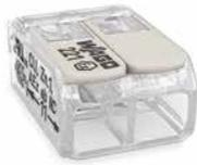
COMPACT-Verbindungsklemme für alle Leiterarten; für Anwendungen Ex eb; max. 4 mm<sup>2</sup>; mit Hebeln; Gehäusefarbe: transparent; Hebefarbe: lichtgrau; Betriebstemperatur max. 105 °C
