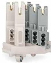
Buchsenteil; mit Rastfüßen und PE-Leiteranschluss; weiß/grau; mit eingespritzter Polkennzeichnung; graues Phasenbuchsenteil auf 1 – 2 – 3 verschiebbar (nicht bei 5-poligen Buchsentteilen)
