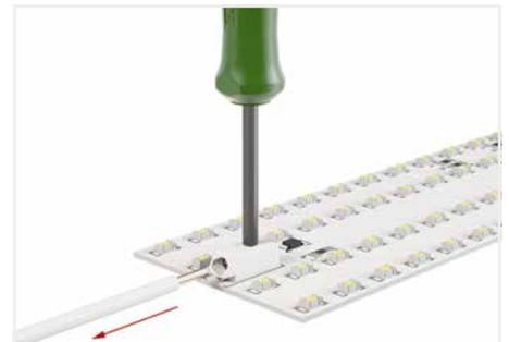
Einfaches Lösen der Leiter z. B. mittels Betätigungswerkzeug 206-859
